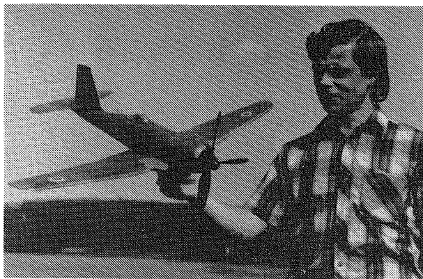
František Jersenský ze Žabčic se představil s úhledným modelem Firebrand. Pěkná čtyřlístá vrtule vznikla malou úpravou dvou vrtulí igr o průměru 240 mm
